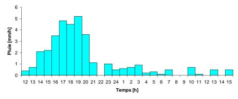
On obtient une lame précipité : Lp = 34.7 mm.
